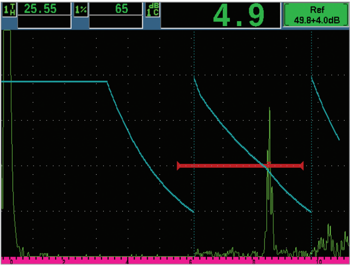
EPOCH 650 com recurso de DAC/TCG dinâmico
