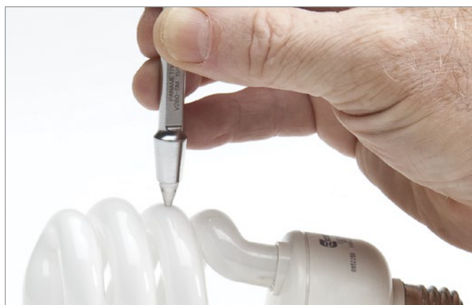
Mede a espessura do vidro com o transdutor V260-SM Sonopen®.
