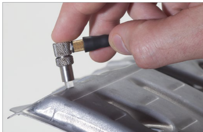
Mede o desbaste do metal causado pela dobra ou pela moldagem.
