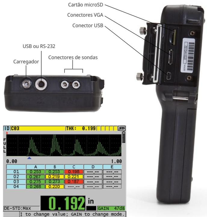
Visualização da grade DB integrada com três cores programáveis
