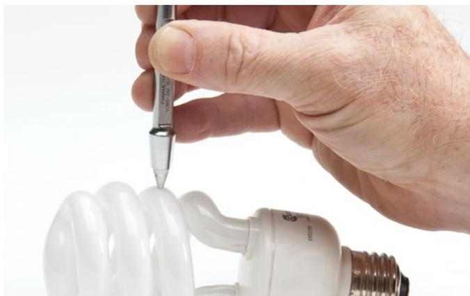
O software opcional High Resolution permite a medição de espessura de até 0,001 mm (0,0001 pol.) de resolução.
