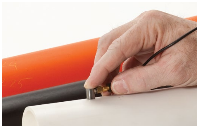
Mede a espessura de vários materiais como plástico, metal, borracha, vidro, cerâmica e compósitos.
