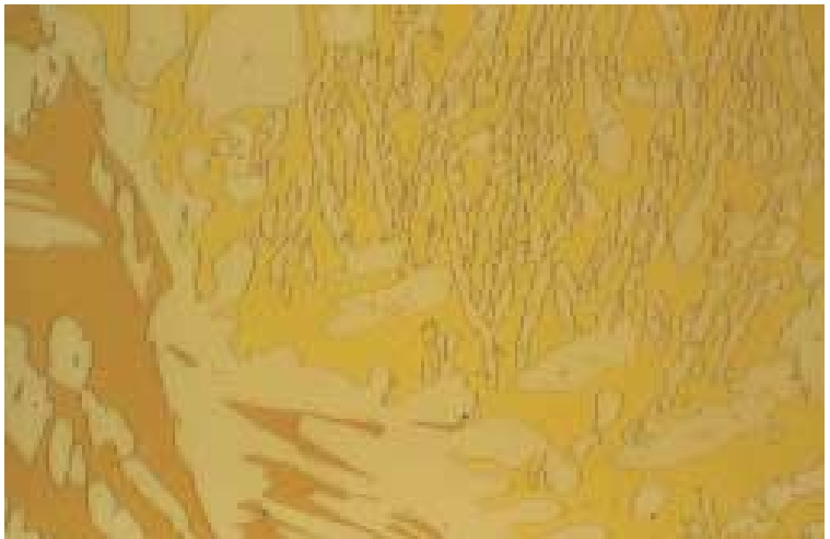
Cu58Zn42 Mag: 500x Etchant: Klemm III
