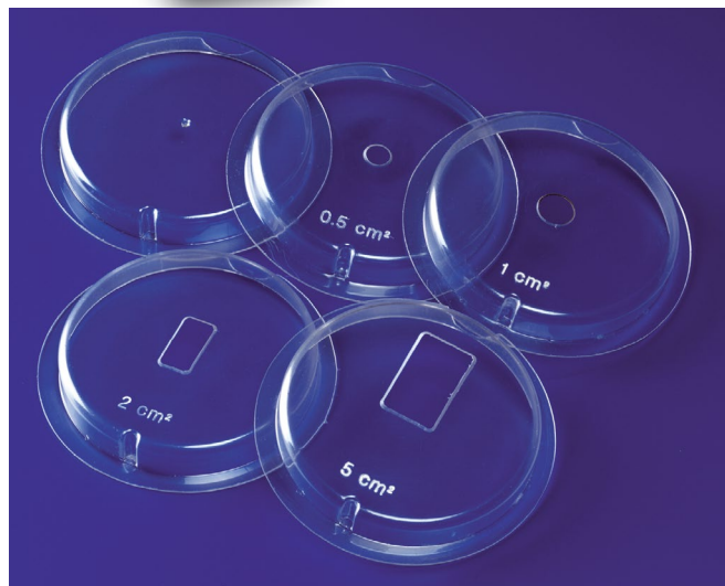
As máscaras transparentes facilitam o monitoramento do nível de eletrólito e o ajuste do fluxo de eletrólito.
