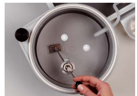
Tampa para colagem de espécimes em seções finas
