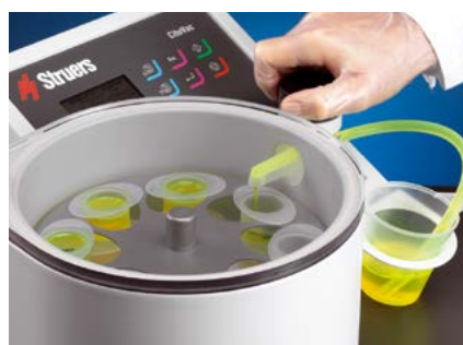
Fácil preenchimento dos moldes de embutimento
