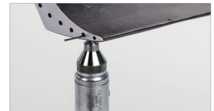
Medição de uma lâmina de turbina usando cabo alvo
