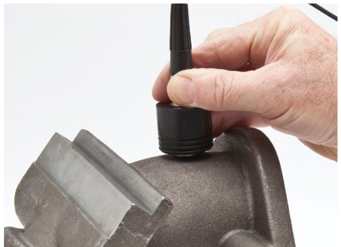
Muitas peças de metal fundido ou materiais atenuantes de som podem ser medidos com o software opcional High Penetration.
