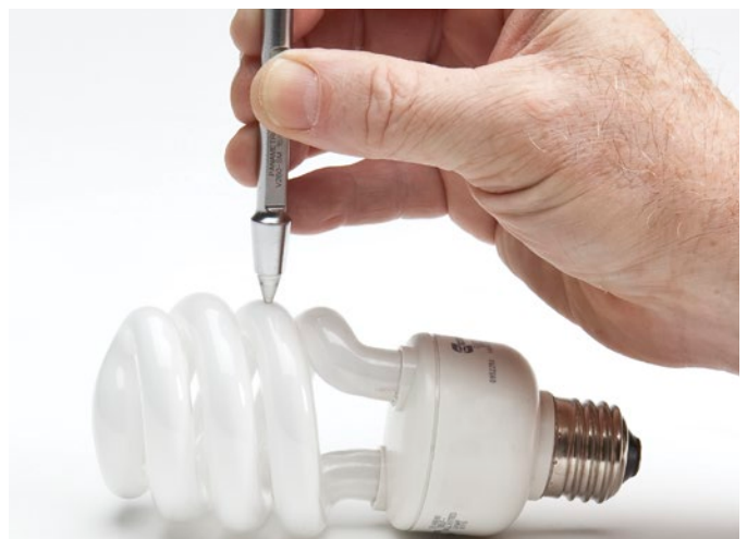
O software opcional High Resolution permite a medição de espessura com resolução de até 0,001 mm.
