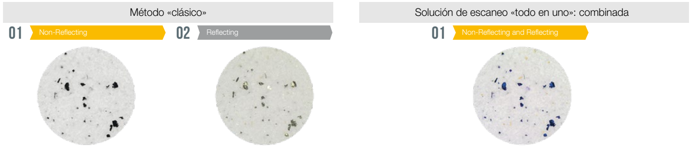
El innovador sistema de iluminación separa partículas reflectantes (metálicas) y no reflectantes (no metálicas) en un solo escaneo.
